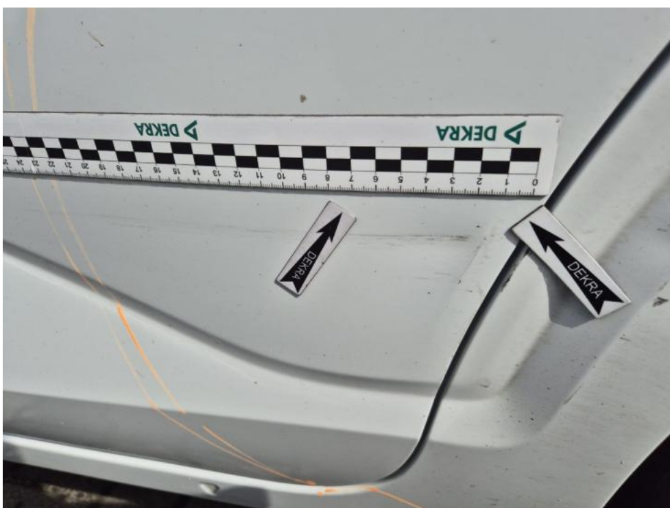
Fot. 40. Drzwi tylne L - Wgniecenie/odkształcenie 1
