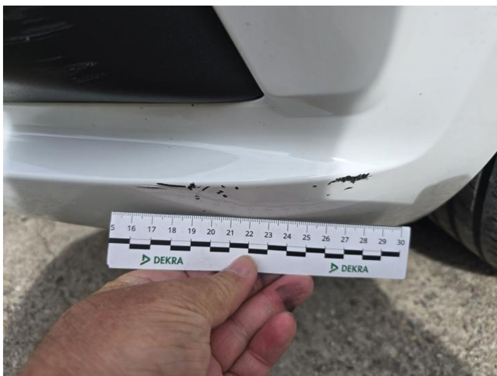
Fot. 38. Zderzak - Rysa/odprysk 1
