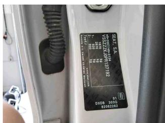
Fahrzeug - Typenschild/Fahrgestellnummer
