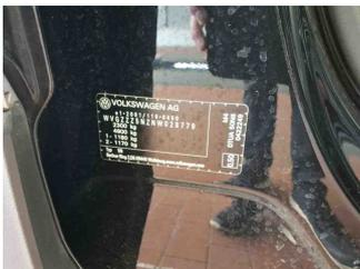
Fahrzeug - Typenschild/Fahrgestellnummer
