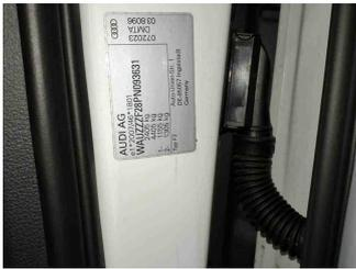
Fahrzeug - Typenschild/Fahrgestellnummer
