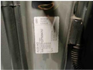
Fahrzeug - Typenschild/Fahrgestellnummer
