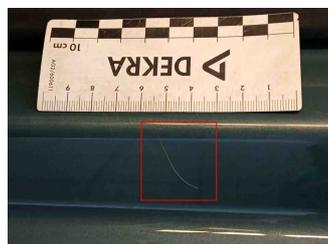
5 - Einstiegsschweller hinten links - Kratzer - Smart Repair
