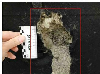
3 - Heckklappe - Delle(n) - Kaltdrücken
