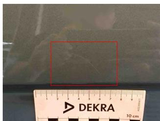
3 - Heckklappe - Kratzer - Akzeptabel (Gebrauchsspur)
