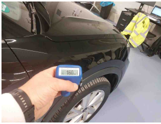
Lackstärke Kotflügel vorne rechts
