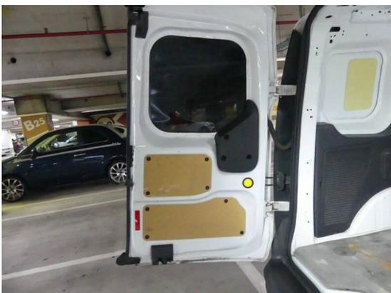
Bild 29: Karosserie / Hecktür links Kratzer+Dellen
