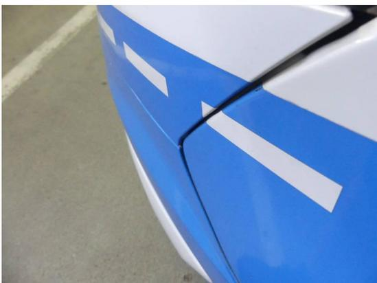
Bild 71: Karosserie / Stoßfänger vorne Einpassung ungenau/nicht befestigt + Kratzer
