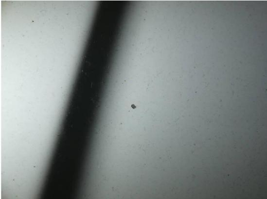
Bild 67: Karosserie / Motorhaube Steinschläge
