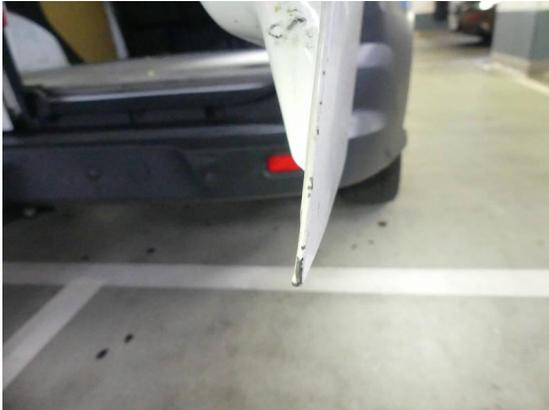
Bild 25: Karosserie / Hecktür rechts Kratzer+Dellen
