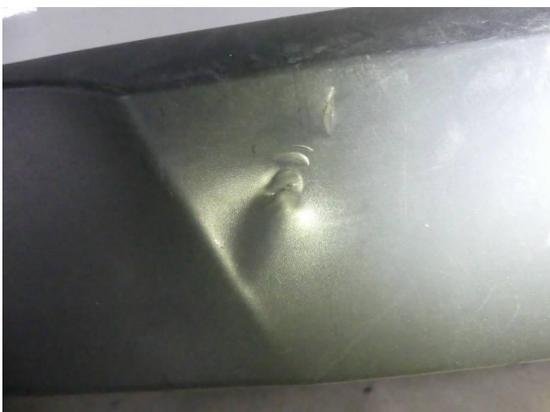
Bild 23: Karosserie / Stoßfänger hinten leicht deformiert und leichte Kratzer
