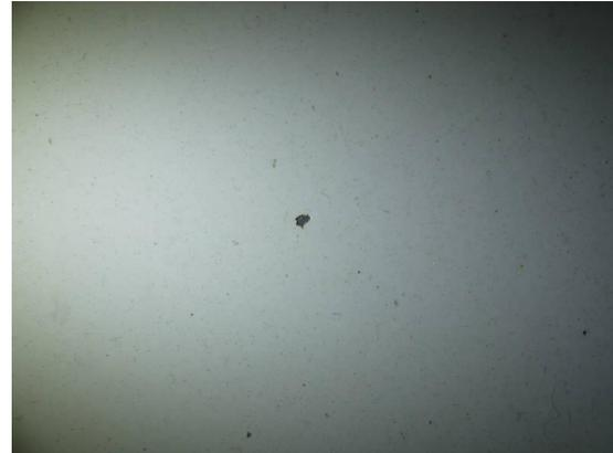
Bild 68: Karosserie / Motorhaube Steinschläge
