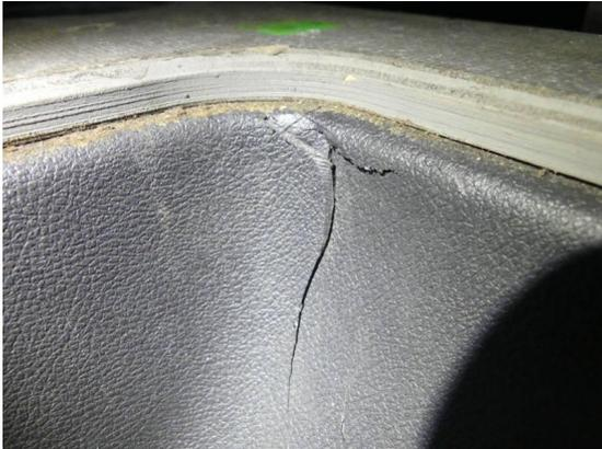
Bild 19: Innenraum / Verkleidung Einstieg hinten rechts gebrochen
