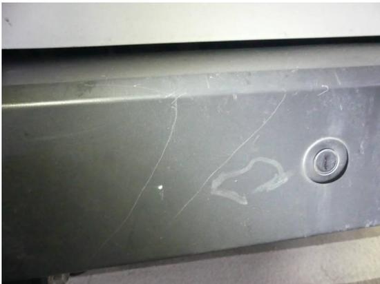
Bild 21: Karosserie / Stoßfänger hinten leicht deformiert und leichte Kratzer
