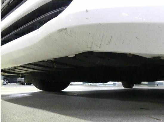
Bild 73: Karosserie / Stoßfänger vorne Einpassung ungenau/nicht befestigt + Kratzer
