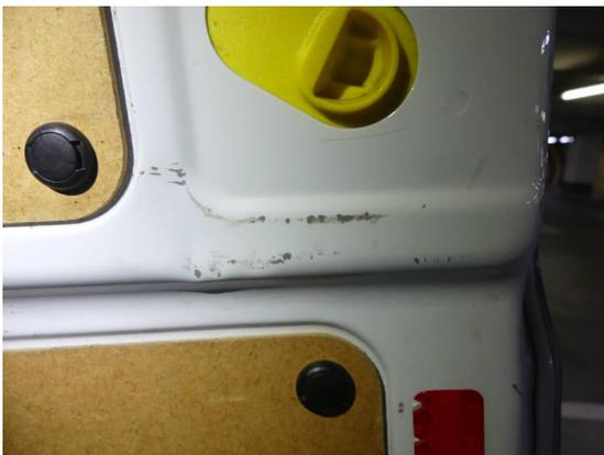
Bild 27: Karosserie / Hecktür rechts Kratzer+Dellen
