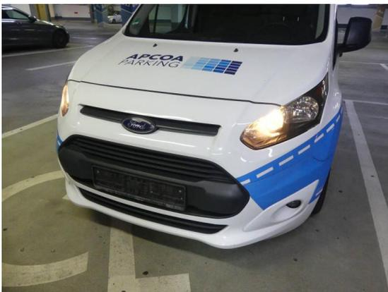
Bild 69: Karosserie / Stoßfänger vorne Einpassung ungenau/nicht befestigt + Kratzer
