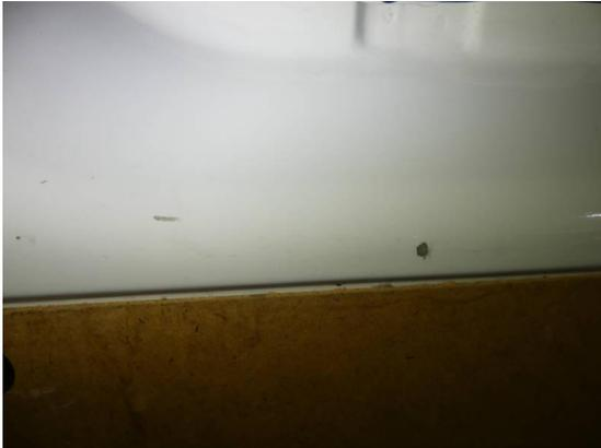
Bild 31: Karosserie / Hecktür links Kratzer+Dellen
