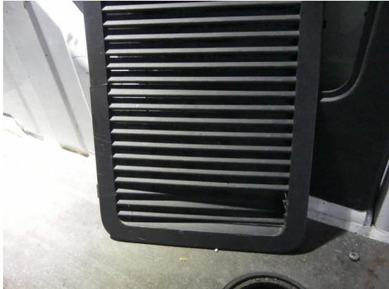
Bild 43: Innenraum / Verkleidung Laderaum hinten rechts gebrochen
