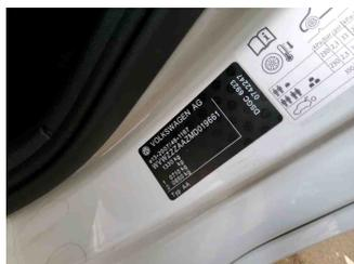
Fahrzeug - Typenschild/Fahrgestellnummer
