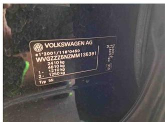
Fahrzeug - Typenschild/Fahrgestellnummer
