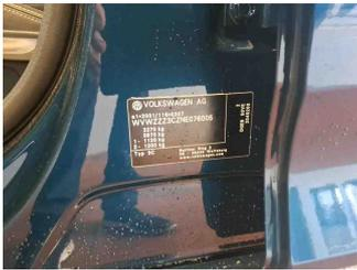
Fahrzeug - Typenschild/Fahrgestellnummer
