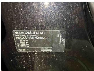
Fahrzeug - Typenschild/Fahrgestellnummer
