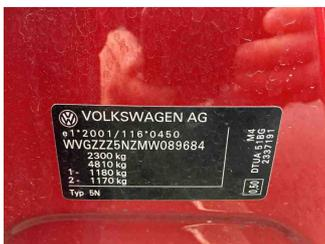
Fahrzeug - Typenschild/Fahrgestellnummer
