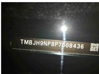
Fahrzeug - Typenschild/Fahrgestellnummer
