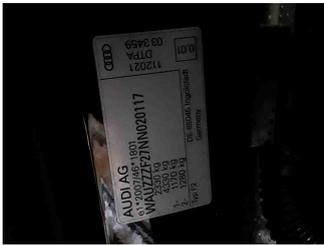
Fahrzeug - Typenschild/Fahrgestellnummer
