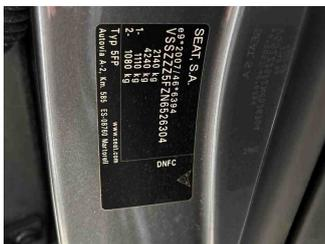
Fahrzeug - Typenschild/Fahrgestellnummer
