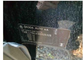
Fahrzeug - Typenschild/Fahrgestellnummer
