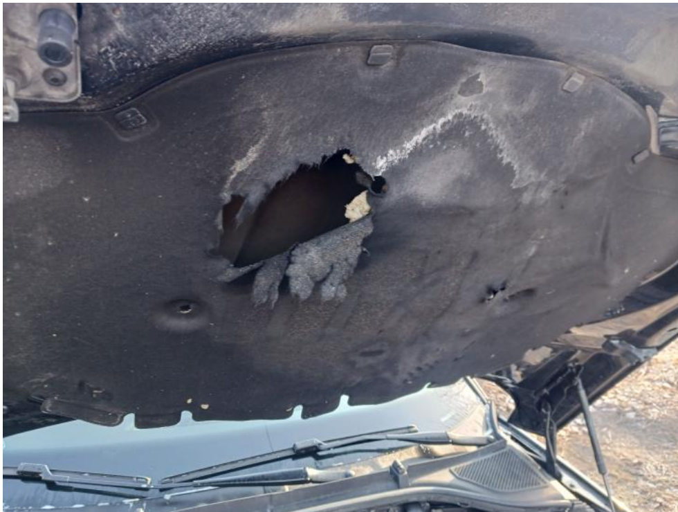
Fot. 41. Wykładzina pokrywy komory silnika - Pęknięcie/rozerwanie 1
