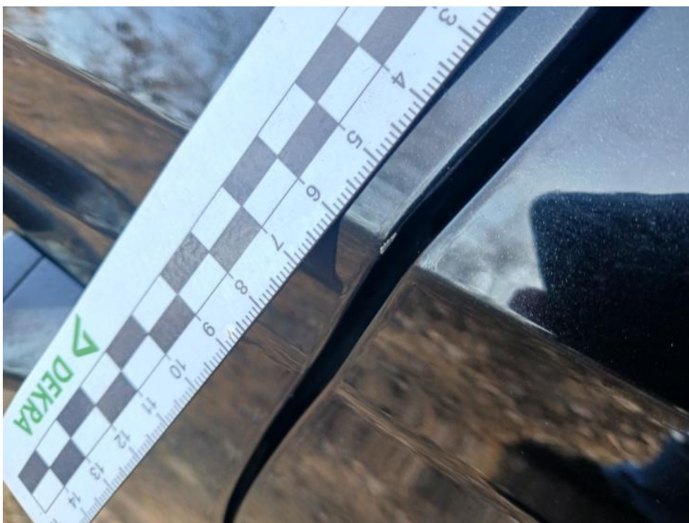
Fot. 58. Drzwi przed L - Rysa/odprysk 1
