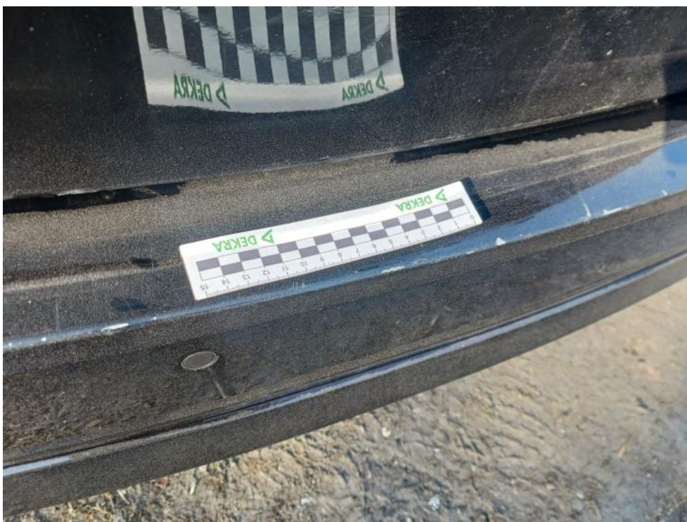
Fot. 57. Zderzak tylny cz őr - Rysa/odprysk 2
