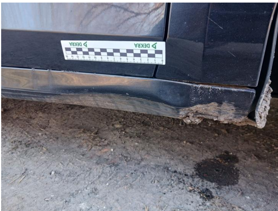
Fot. 52. Próg P - Wgniecenie/odkształcenie 1
