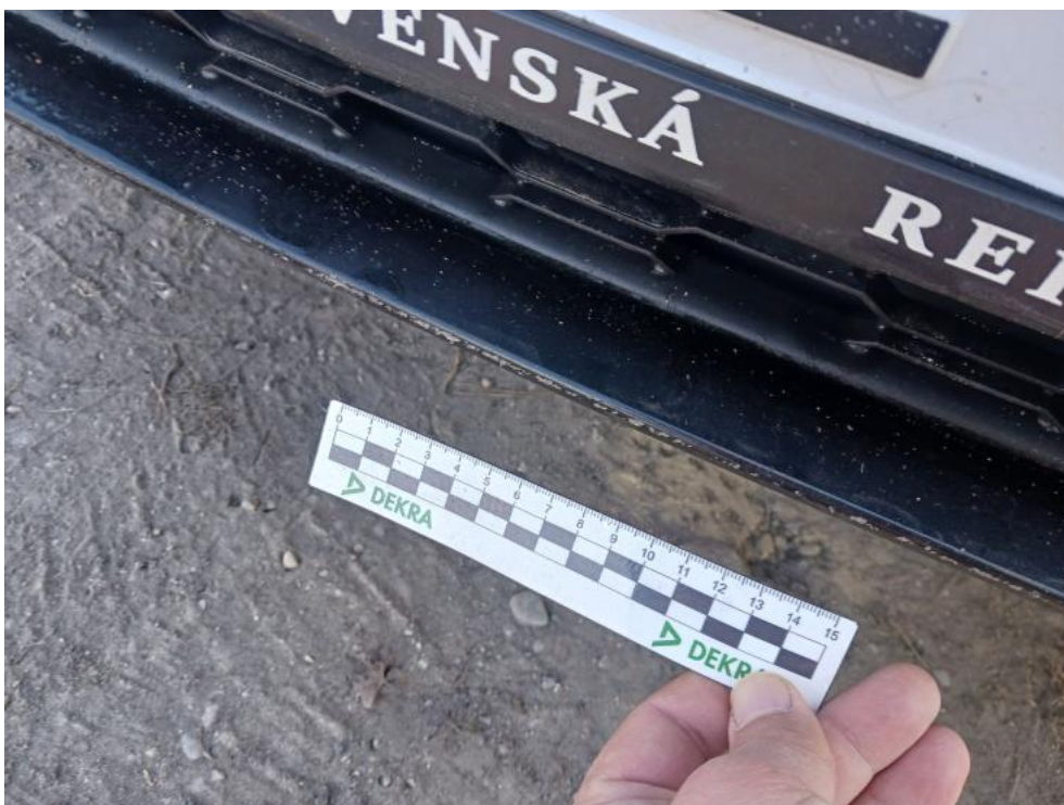
Fot. 42. Zderzak przedni cz dolna - Rysa/odprysk 1
