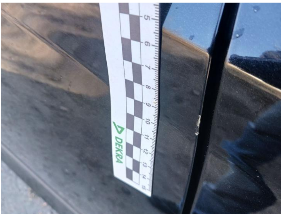
Fot. 51. Drzwi tylne P - Rysa/odprysk 2
