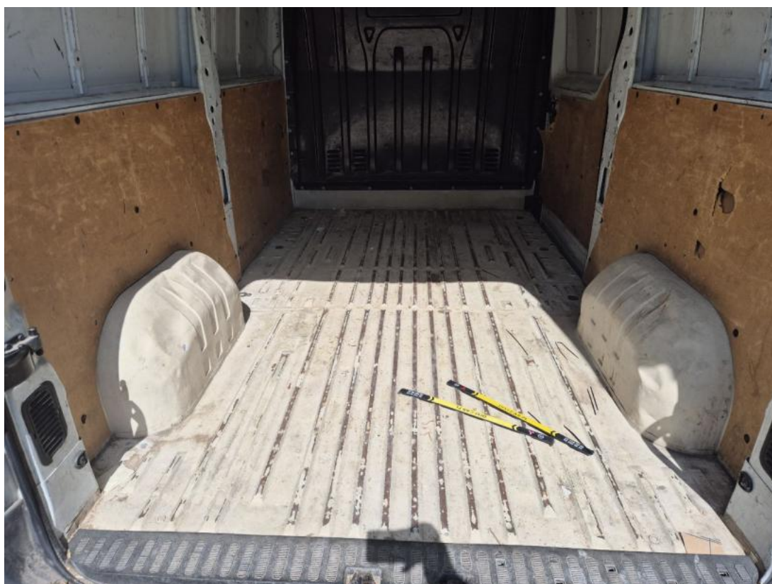
Fot. 112 Podłoga - Rysa/odprysk 1
