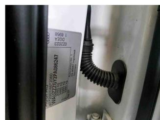
Fahrzeug - Typenschild/Fahrgestellnummer
