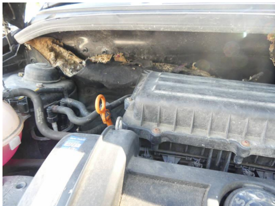
Bild 1: Technik / Dämmmatte Spritzwand zerrissen
