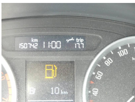
Bild 17: Wartung-Pflege / Wartung fällig
