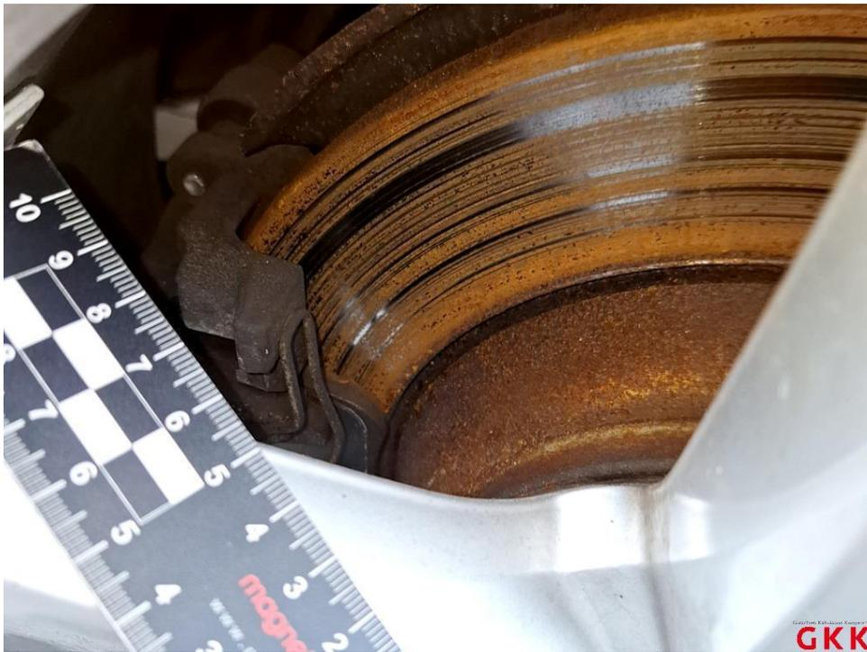
Bild 16 Bremsscheiben, komplett, korrodiert, ersetzen
