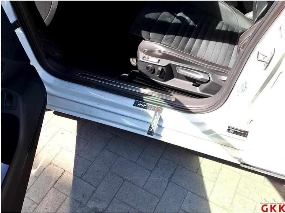
Bild 27 Tür vorne links, Einstieg, verkratzt, Smartrepair
