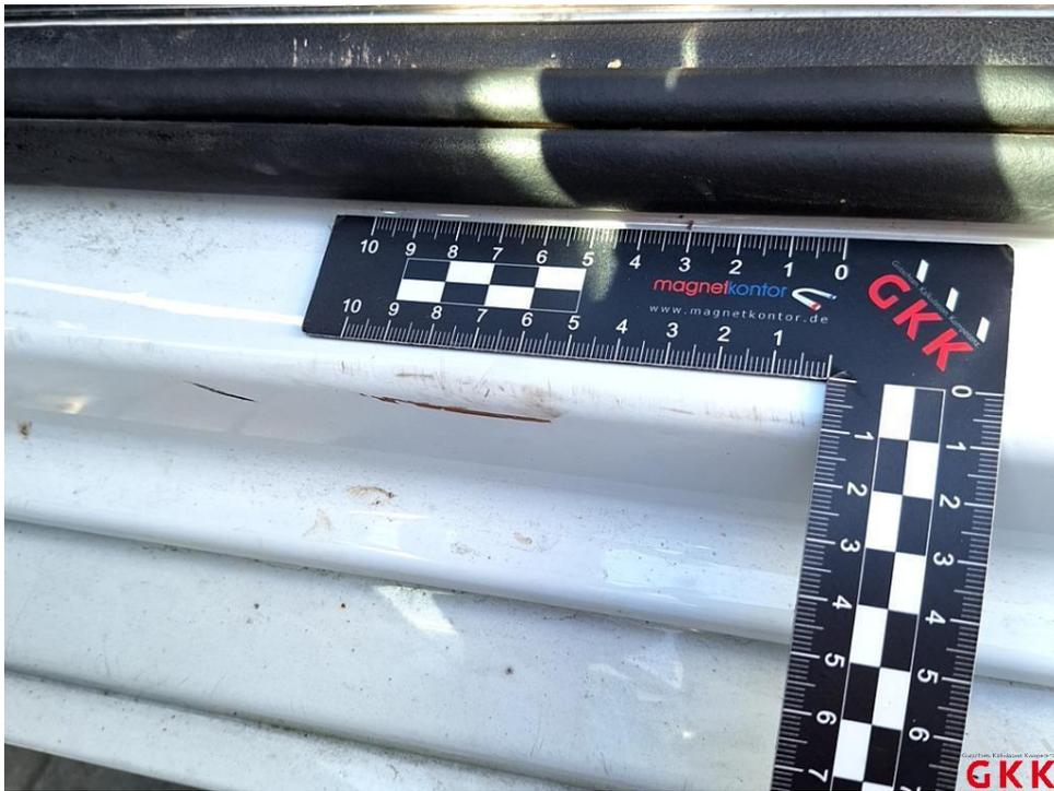
Bild 28 Tür vorne links, Einstieg, verkratzt, Smartrepair
