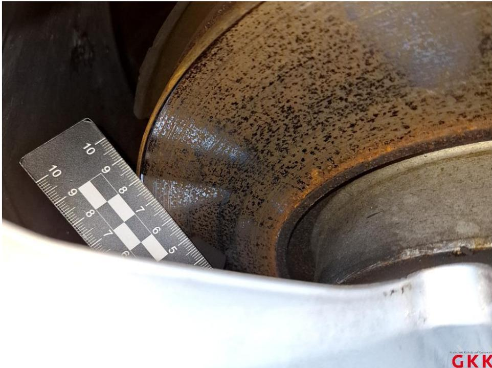
Bild 15 Bremsscheiben, komplett, korrodiert, ersetzen
