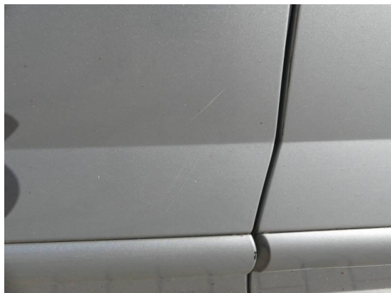
Bild 7: Karosserie / Tür vorne links Dellen und zerkratzt
