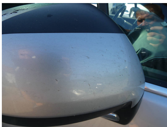
Bild 54: Karosserie / Spiegelkappe rechts Kratzer
