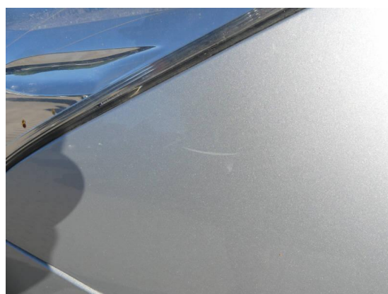
Bild 64: Karosserie / Kotflügel links zerkratzt
