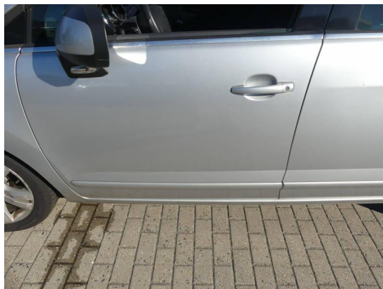
Bild 8: Karosserie / Tür vorne links Dellen und zerkratzt
