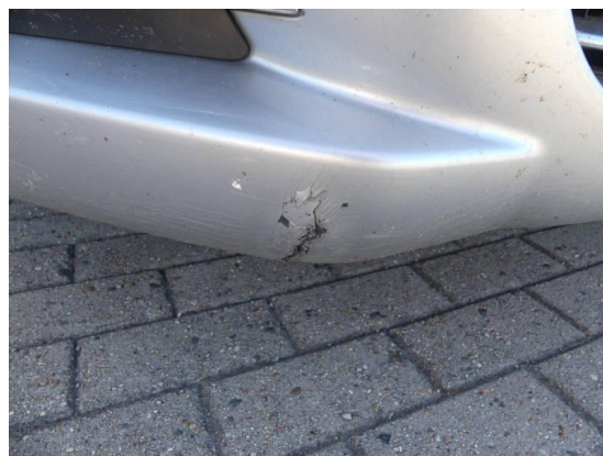
Bild 62: Karosserie / Stoßfänger vorn gebrochen und zerkratzt
