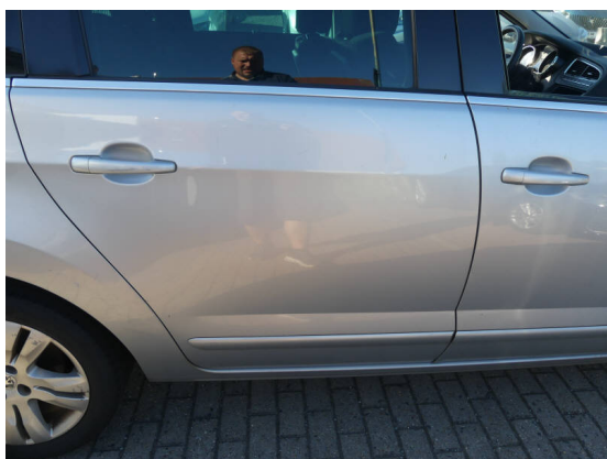
Bild 45: Karosserie / Tür hinten rechts zerkratzt
