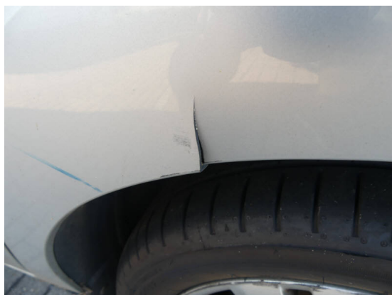
Bild 55: Karosserie / Kotflügel rechts gebrochen und zerkratzt
