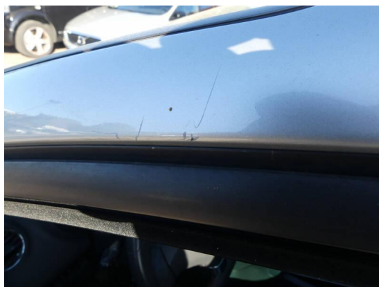
Bild 68: Karosserie / A-Säule links zerkratzt
