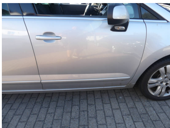
Bild 53: Karosserie / Tür vorne rechts deformiert und zerkratzt
