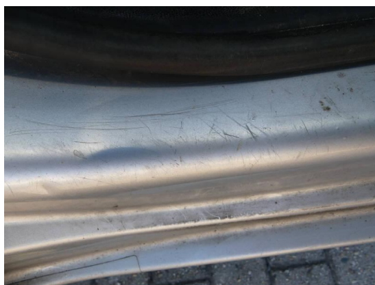
Bild 40: Karosserie / Einstieg hinten rechts Dellen und zerkratzt
