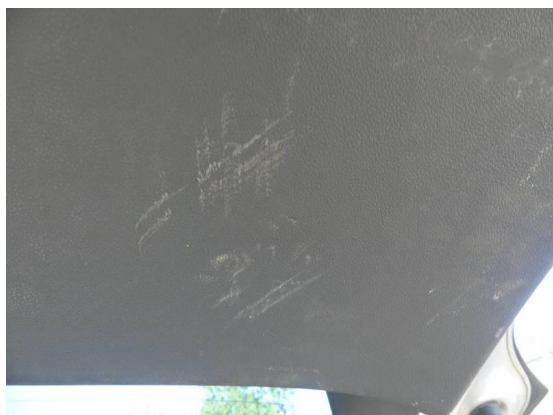
Bild 49: Innenraum / Heckklappenverkleidung Kratzer
