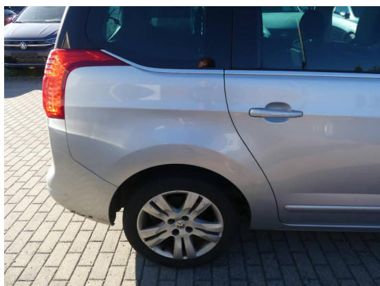
Bild 39: Karosserie / Seitenteil rechts deformiert und zerkratzt
