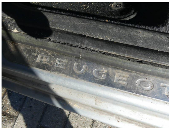
Bild 5: Technik / Dichtgummi Tür vorne links gerissen
