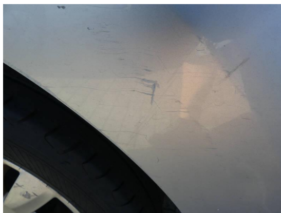
Bild 38: Karosserie / Seitenteil rechts deformiert und zerkratzt
