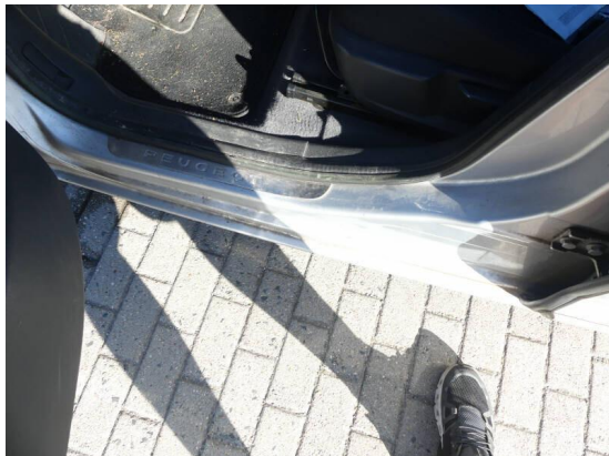
Bild 3: Karosserie / Einstieg vorne links zerkratzt
