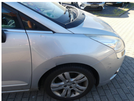
Bild 56: Karosserie / Kotflügel rechts gebrochen und zerkratzt
