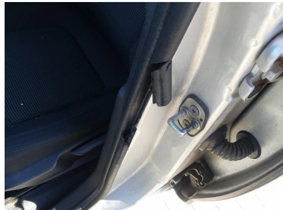
Bild 4: Technik / Dichtgummi Tür vorne links gerissen
