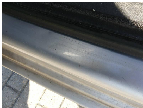
Bild 14: Karosserie / Einstieg hinten links Delle und zerkratzt
