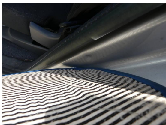
Bild 21: Karosserie / C-Säule links Dellen
