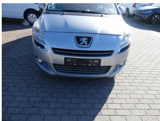
Bild 63: Karosserie / Stoßfänger vorn gebrochen und zerkratzt
