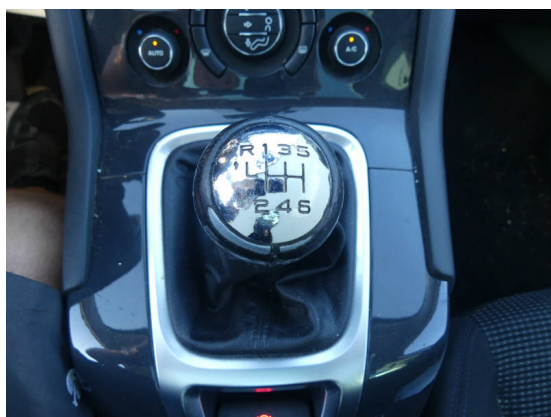
Bild 57: Innenraum / Schaltknauf abgegriffen
