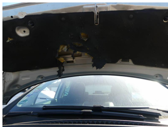
Bild 26: Technik / Dämmmatte Motorhaube zerrissen
