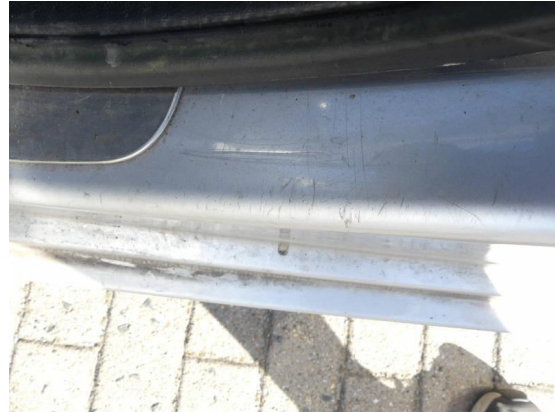
Bild 2: Karosserie / Einstieg vorne links zerkratzt
