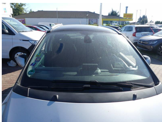
Bild 59: Karosserie / Frontscheibe Steinschlag
