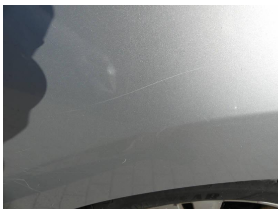
Bild 23: Karosserie / Seitenteil links zerkratzt
