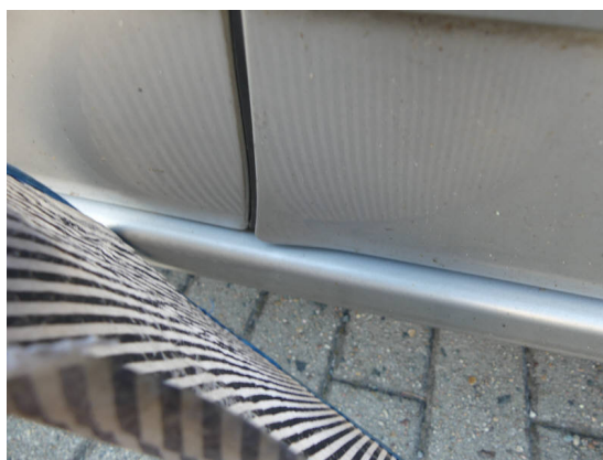
Bild 52: Karosserie / Tür vorne rechts deformiert und zerkratzt
