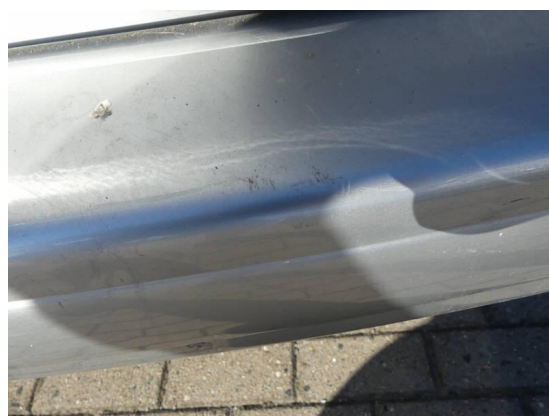
Bild 30: Karosserie / Stoßfänger hinten zerkratzt
