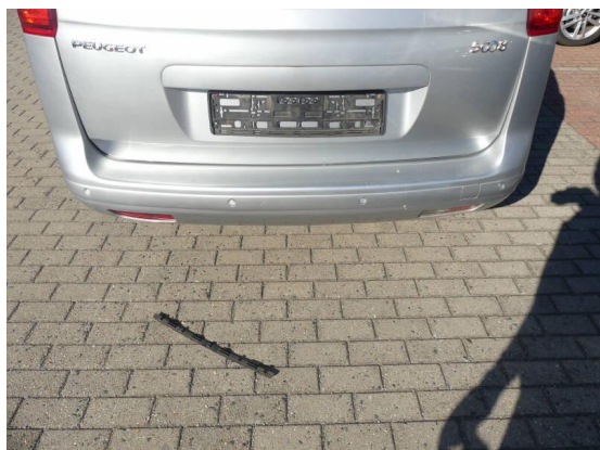
Bild 31: Karosserie / Stoßfänger hinten zerkratzt
