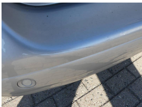
Bild 29: Karosserie / Stoßfänger hinten zerkratzt
