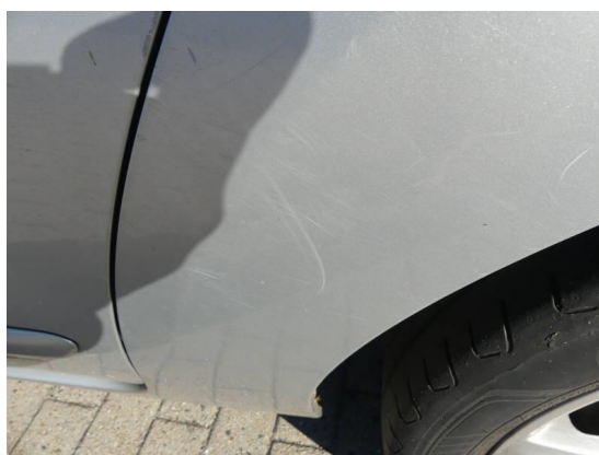
Bild 24: Karosserie / Seitenteil links zerkratzt
