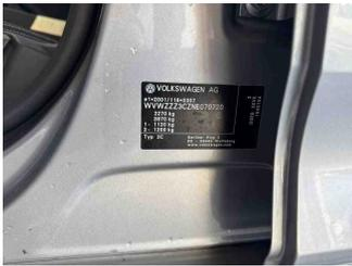
Fahrzeug - Typenschild/Fahrgestellnummer
