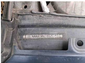
Fahrzeug - Typenschild/Fahrgestellnummer
