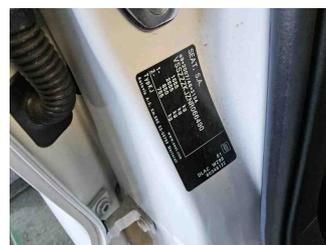
Fahrzeug - Typenschild/Fahrgestellnummer
