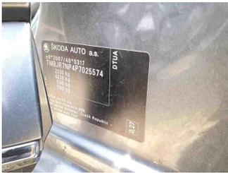
Fahrzeug - Typenschild/Fahrgestellnummer
