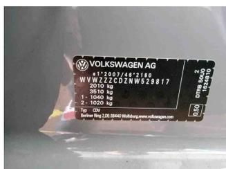
Fahrzeug - Typenschild/Fahrgestellnummer
