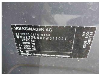
Fahrzeug - Typenschild/Fahrgestellnummer
