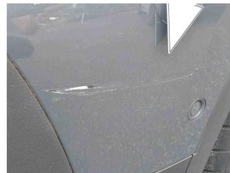
11 - Kotflügelzierleiste vorne rechts - Delle(n) und Kratzer - Ersetzen
