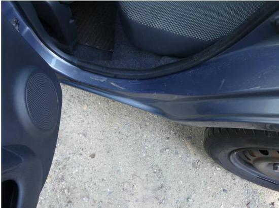
Bild 37: Karosserie / Einstieg hinten links zerkratzt
