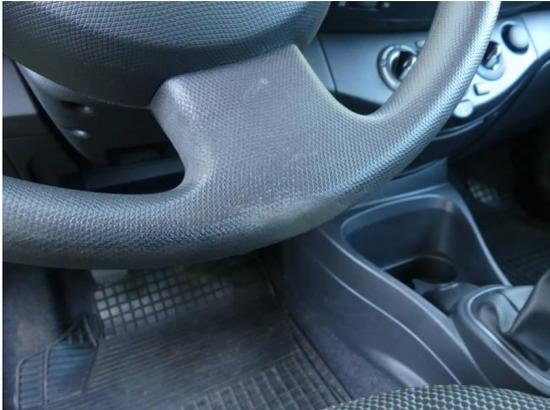
Bild 31: Innenraum / Lenkrad abgegriffen
