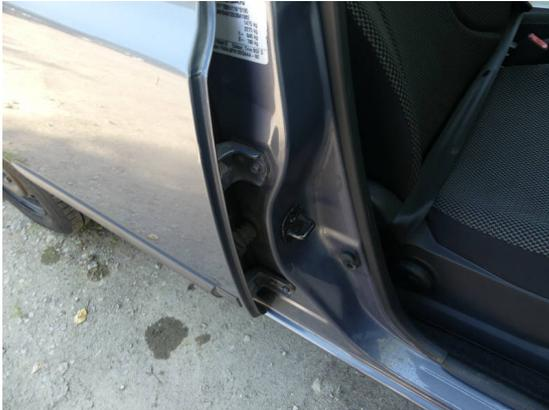
Bild 19: Karosserie / B-Säule rechts Kratzer
