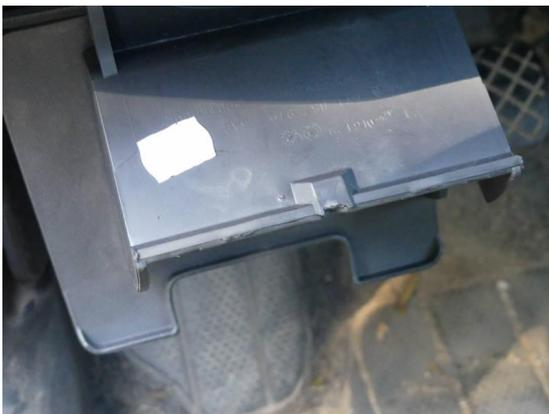
Bild 39: Innenraum / Ablagefach im Armaturenbrett links hält nicht mehr
