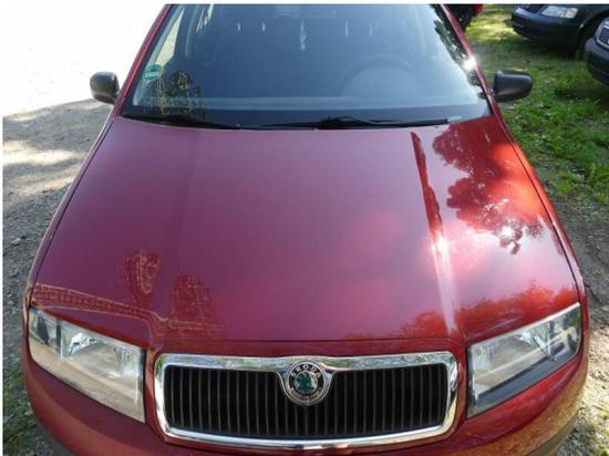
Bild 3: Karosserie / Motorhaube Steinschlag und zerkratzt
