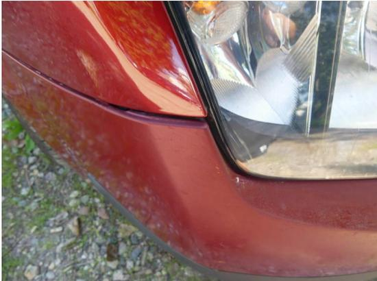
Bild 25: Karosserie / Stoßfänger vorn Passform ungenau, Klarlack fehlt und deformiert
