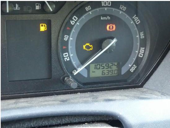
Bild 37: Technik / Motorkontrollleuchte leuchtet ( keine Kommunikation zum Steuergerät
