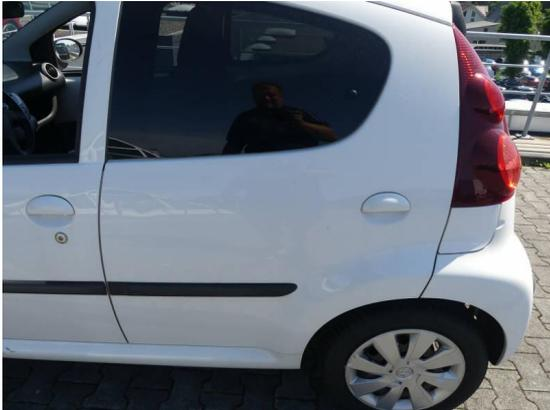
Bild 13: Karosserie / Tür hinten links leicht deformiert
