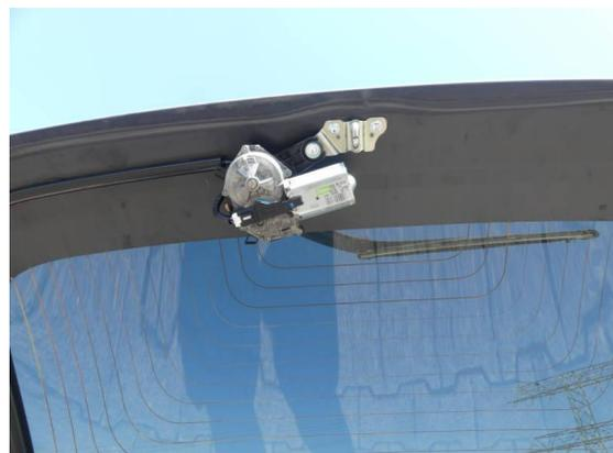
Bild 18: Innenraum / Abdeckung Wischermotor hinten fehlt
