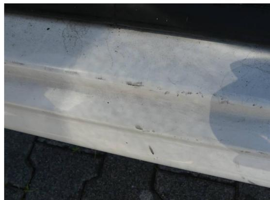
Bild 6: Karosserie / Einstieg vorne links zerkratzt
