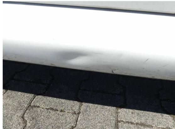
Bild 16: Karosserie / Schweller rechts eingedrückt
