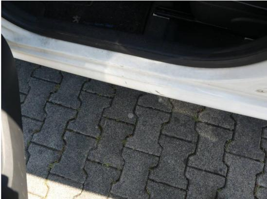
Bild 7: Karosserie / Einstieg vorne links zerkratzt
