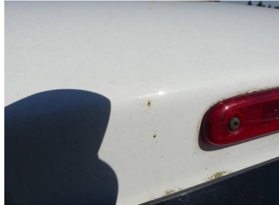
Bild 14: Karosserie / Dachkante hinten Korrosion
