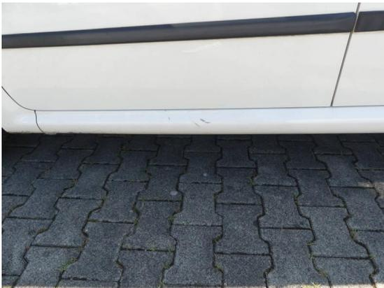
Bild 9: Karosserie / Schweller links Kratzer
