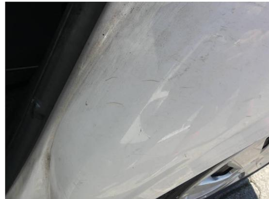
Bild 10: Karosserie / Einstieg hinten links zerkratzt
