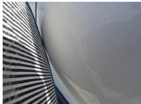
Bild 12: Karosserie / Tür hinten links leicht deformiert
