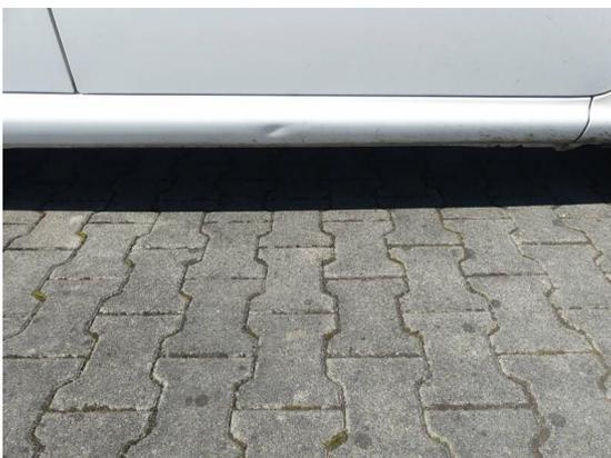
Bild 17: Karosserie / Schweller rechts eingedrückt
