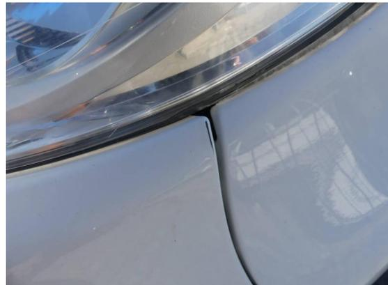
Bild 4: Karosserie / Stoßfänger vorn zerkratzt
