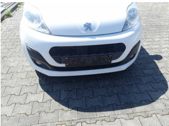
Bild 5: Karosserie / Stoßfänger vorn zerkratzt
