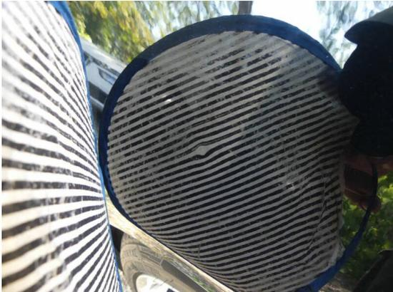
Bild 7: Karosserie / Seitenteil links leicht deformiert und zerkratzt
