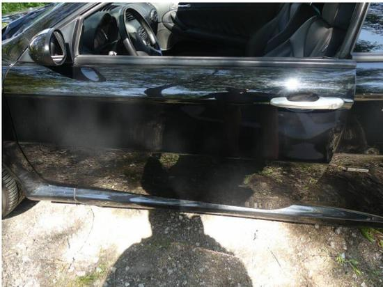
Bild 3: Karosserie / Tür links deformiert
