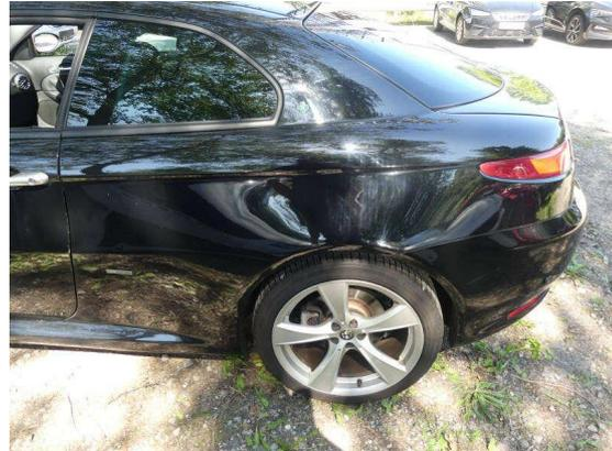
Bild 8: Karosserie / Seitenteil links leicht deformiert und zerkratzt
