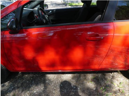
Bild 13: Karosserie / Tür links Steinschlag und Lackabplatzer
