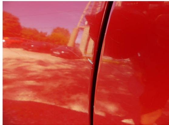
Bild 22: Karosserie / Seitenteil rechts zerkratzt
