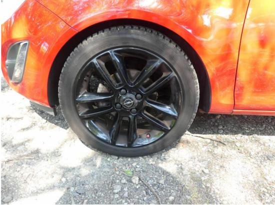
Bild 31: Reifen - Felge / Felgen ( alle ) zerkratzt
