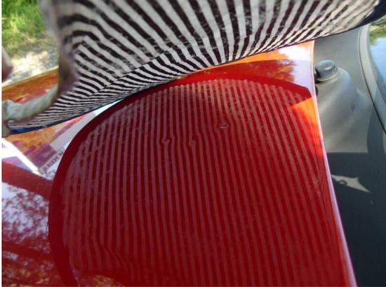
Bild 1: Karosserie / Motorhaube deformiert und zerkratzt
