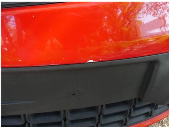
Bild 9: Karosserie / Stoßfänger vorn zerkratzt
