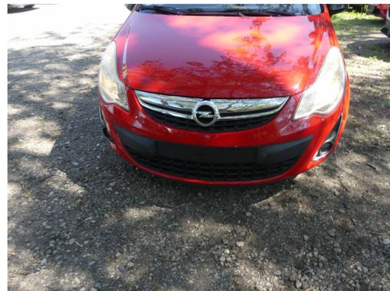
Bild 10: Karosserie / Stoßfänger vorn zerkratzt
