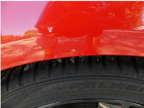
Bild 21: Karosserie / Seitenteil rechts zerkratzt
