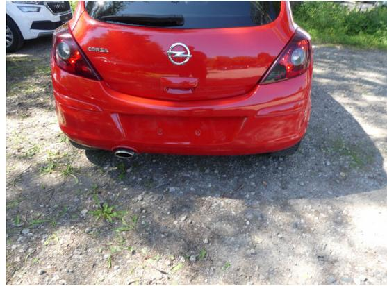
Bild 20: Karosserie / Stoßfänger hinten gebrochen und zerkratzt
