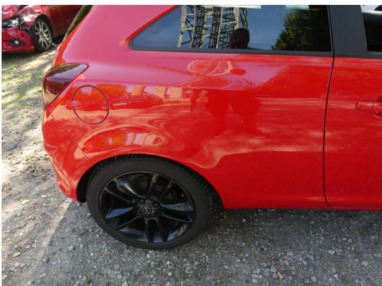
Bild 23: Karosserie / Seitenteil rechts zerkratzt
