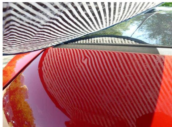
Bild 24: Karosserie / Dachholm rechts Delle mit Kratzer
