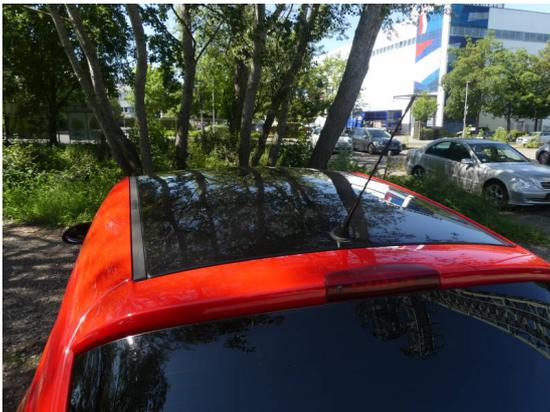
Bild 15: Karosserie / Dach Delle mit Kratzer
