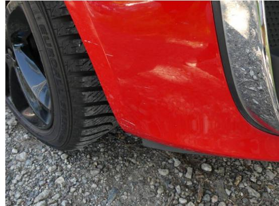
Bild 8: Karosserie / Stoßfänger vorn zerkratzt
