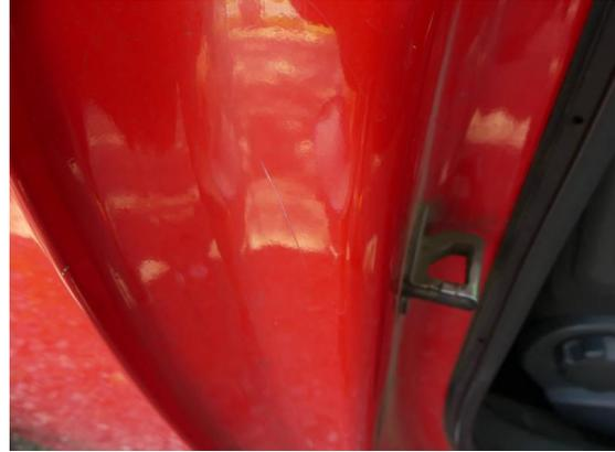
Bild 26: Karosserie / B-Säule rechts Kratzer
