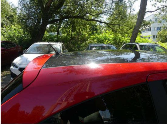
Bild 25: Karosserie / Dachholm rechts Delle mit Kratzer
