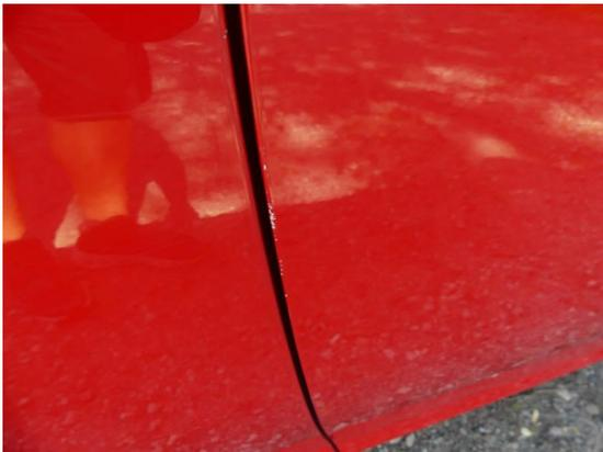
Bild 3: Karosserie / Tür rechts Lackabplatzer und zerkratzt
