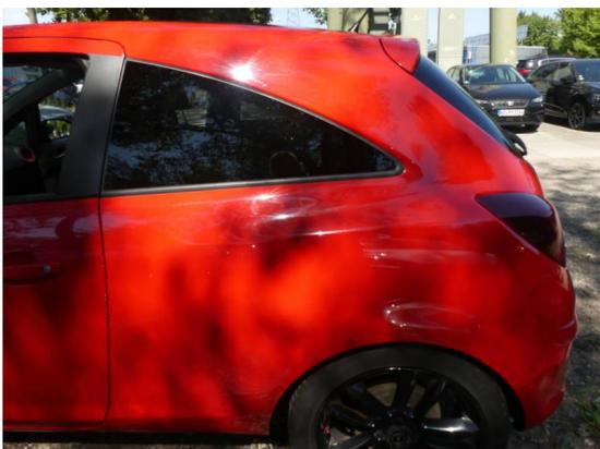
Bild 17: Karosserie / Seitenteil links Delle mit Kratzer
