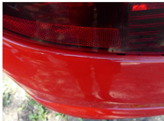
Bild 18: Karosserie / Stoßfänger hinten gebrochen und zerkratzt
