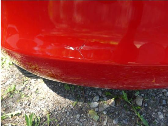
Bild 19: Karosserie / Stoßfänger hinten gebrochen und zerkratzt
