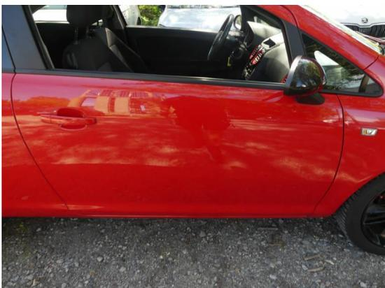
Bild 5: Karosserie / Tür rechts Lackabplatzer und zerkratzt
