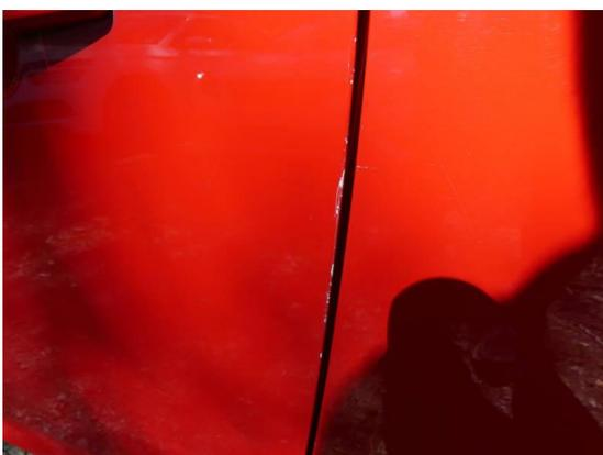
Bild 11: Karosserie / Tür links Steinschlag und Lackabplatzer
