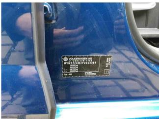
Fahrzeug - Typenschild/Fahrgestellnummer
