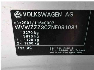
Fahrzeug - Typenschild/Fahrgestellnummer
