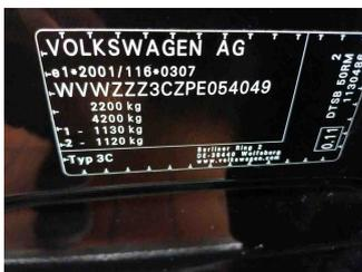
Fahrzeug - Typenschild/Fahrgestellnummer
