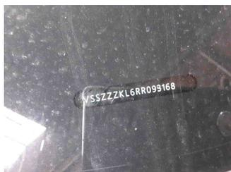
Fahrzeug - Typenschild/Fahrgestellnummer
