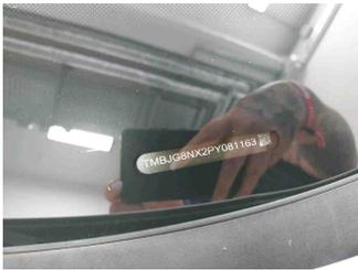
Fahrzeug - Typenschild/Fahrgestellnummer
