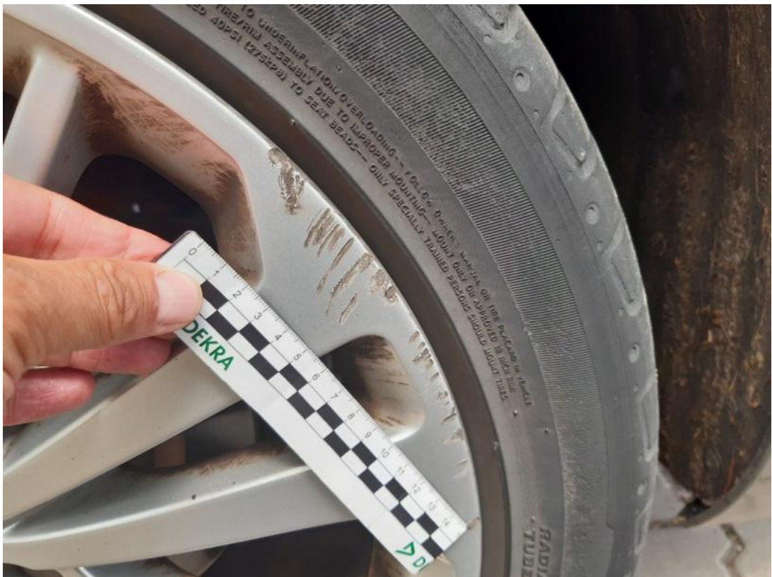
Felga aluminiowa tylna L - Rysa/odprysk 1
