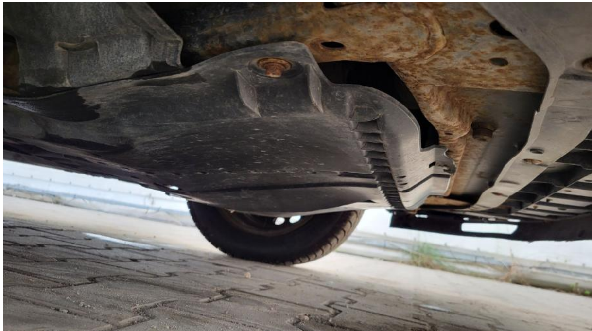
Fot. 32 Ośłona dolna silnika - Pęknięcie/rozerwanie 1
