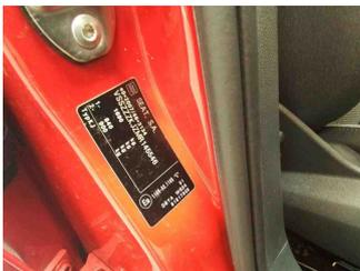
Fahrzeug - Typenschild/Fahrgestellnummer
