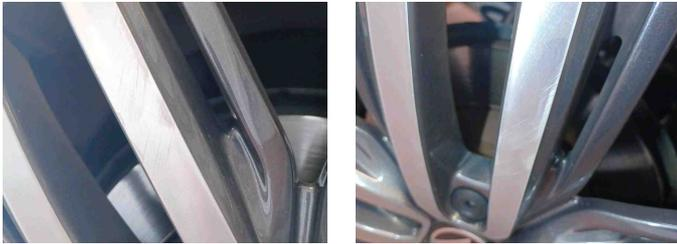
2 - Alufelge glanzgedreht vorne rechts - Kratzer - Polieren
