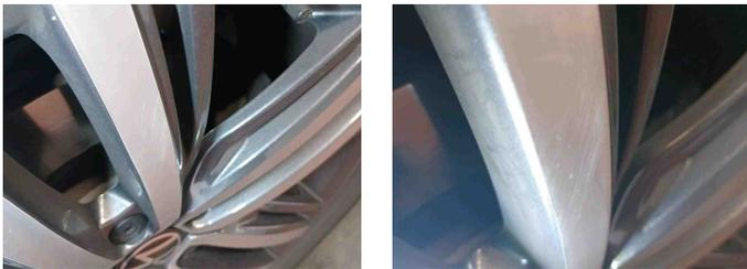
3 - Alufelge glanzgedreht hinten links - Kratzer - Polieren
