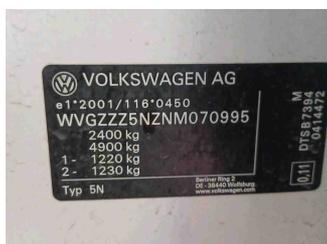
Fahrzeug - Typenschild/Fahrgestellnummer
