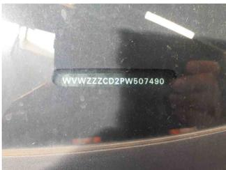
Fahrzeug - Typenschild/Fahrgestellnummer
