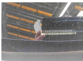
Fahrzeug - Typenschild/Fahrgestellnummer
