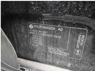
Fahrzeug - Typenschild/Fahrgestellnummer
