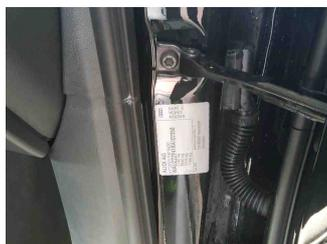
Fahrzeug - Typenschild/Fahrgestellnummer
