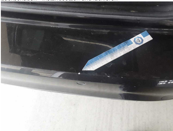
Beschädigung #4: Stossfänger hinten: Stossfänger hinten - Kratzer - lackieren
