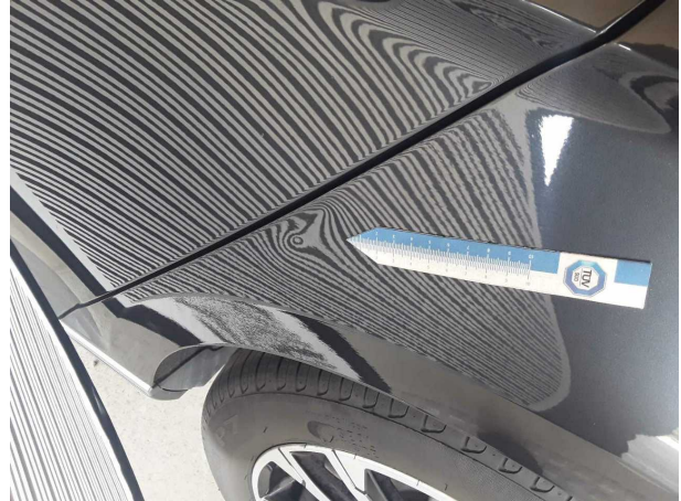
Beschädigung #1: Seitenwand links: Seitenwand - Delle(n) - sanft instandsetzen
