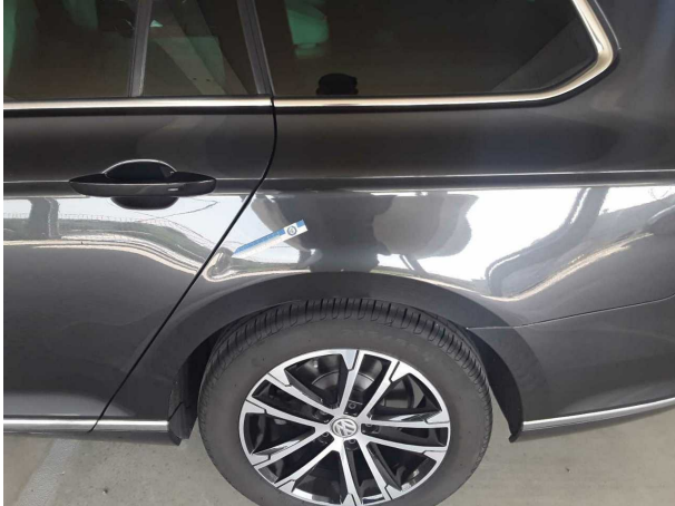
Beschädigung #1: Seitenwand links: Seitenwand - Delle(n) - sanft instandsetzen
