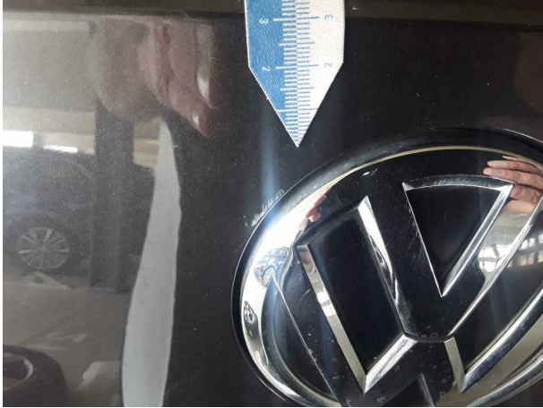
Beschädigung #3: Heckklappe/-tür: Heckklappe - Delle / Lackschaden - instandsetzen und lackieren
