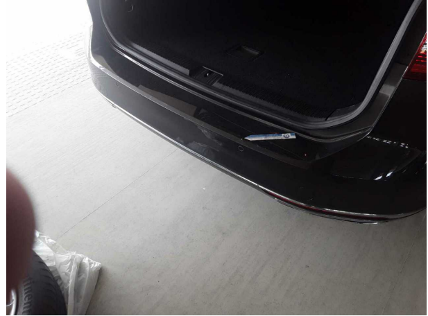
Beschädigung #4: Stossfänger hinten: Stossfänger hinten - Kratzer - lackieren
