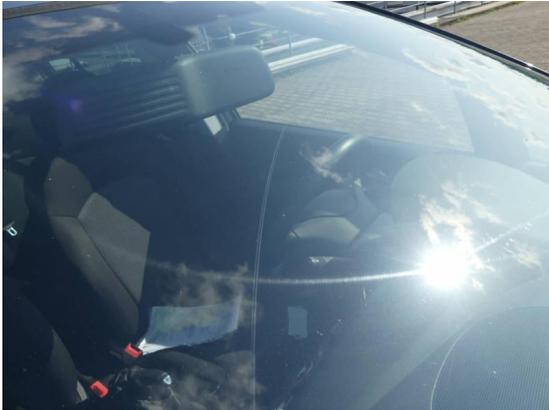
Bild 25: Karosserie / Frontscheibe zerkratzt
